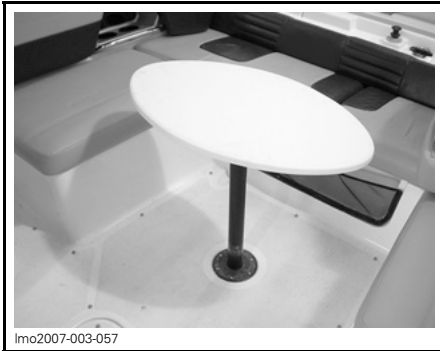
TYPISCH - COCKPIT-TISCH INSTALLIERT
