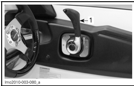
1. Gas-/schakelhendel in neutraal.
