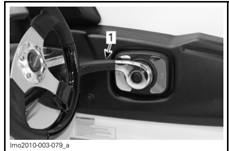
1. Gas-/schakelhendel in de stand volle gas vooruit.
