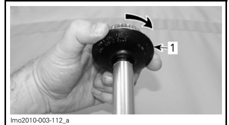
1. Losschrauben und abziehen
