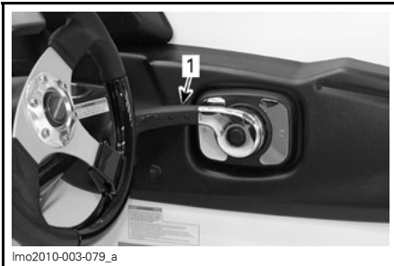
1. Gas-/Schalthebel in Vorwärtsstellung (Vollgas)
