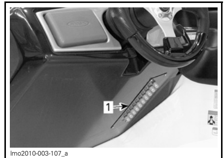
1. Einbauort der Trennschalterkonsole
