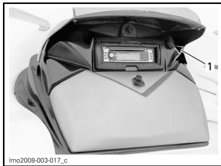
1. 12-volt power outlet
