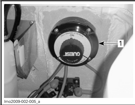
TYPISCH — BATTERIEHAUPTSCHALTER 1. Batteriehaupschalter in ausgeschalteter Position (OFF)
