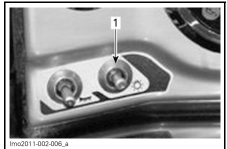
1. Schalter für Positionsleuchten
