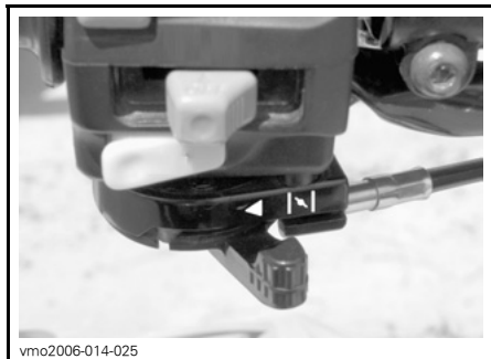
TÍPICO — ALAVANCA DO AFOGADOR NA POSIÇÃO OFF (DESATIVADO)
