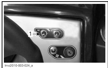
1. Interrupteur du système de chauffage
