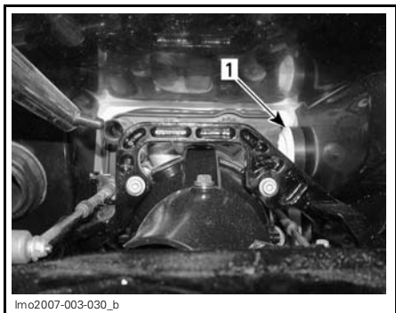
1. Clapet de cale
