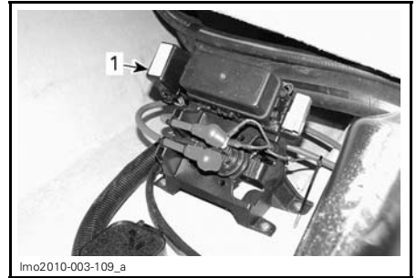
1. Porte-fusibles du système de charge
