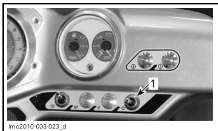
1. Interrupteur HAUT et BAS
