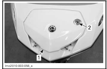
1. Couvercle de l'échelle avant 2. Verrou
