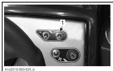
1. Interrupteur de système de lest
