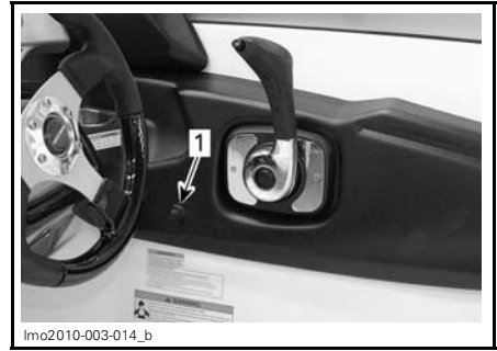
1. Interrupteur coupe-circuit des moteurs
