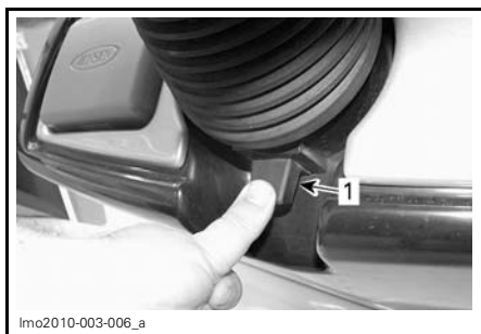
APPUYER SUR LE BOUTON ET LE TENIR POUR RÉGLER LE VOLANT
