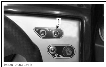
1. Interrupteur du système de lest
