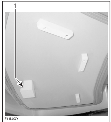
TYPISCH 1. L-förmige Halterung
