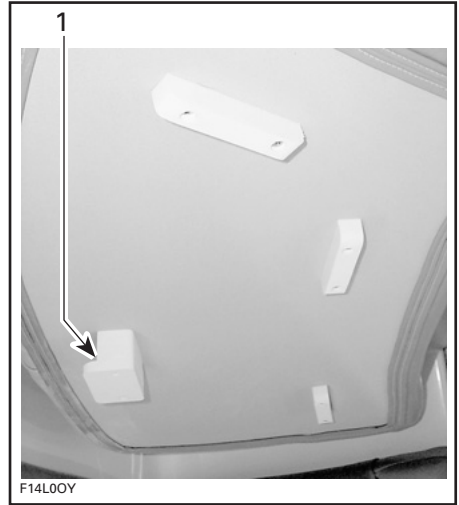
TYPISCH 1. L-förmige Halterung
