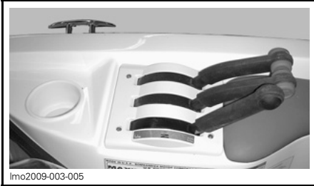
TYPISCH— SCHALTHEBEL IN RÜCKWÄRTSSTELLUNG
