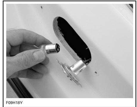
SITUAZIONE TIPICA — SPINGERE DENTRO, RUOTARE E RIMUOVERE LA LAMPADINA
