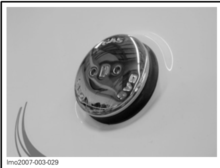
TÍPICO - TAMPA DO TANQUE DE COMBUSTÍVEL
