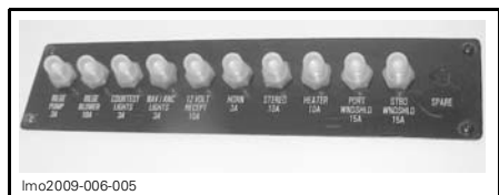
PANNEAU À DISJONCTEURS
