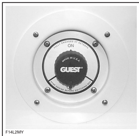
SITUAZIONE TIPICA — INTERRUOTTORE BATTERIA PRINCIPALE
