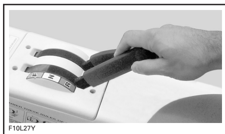
TYPIQUE — LEVIER SÉLECTEUR EN POSITION DE MARCHÉ ARRIÈRE
