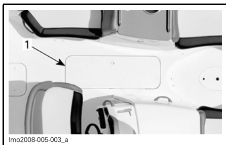
1. Compartimento de almacenamiento de la cubierta
