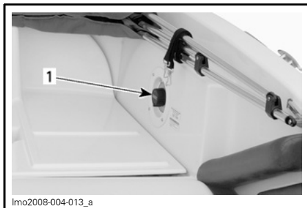
1. Interruptor principal de corte da bateria
