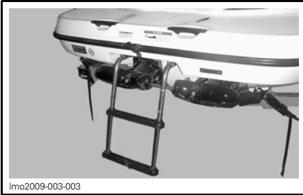
Imo2009-003-003 SITUAZIONE TIPICA — SCALETTA ABBASSATA
