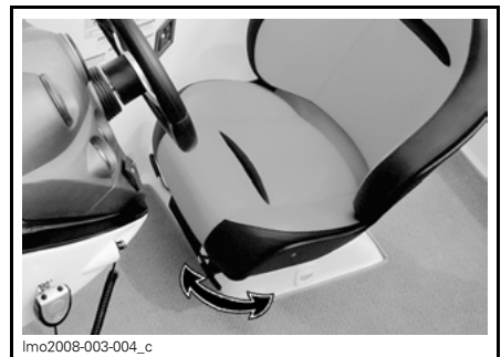
Imo2008-003-004_c SITUAZIONE TIPICA — ROTAZIONE DEL SEDILE
