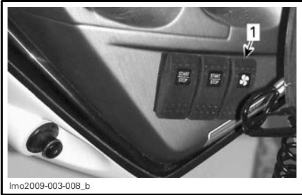
1. Bilge blower switch
