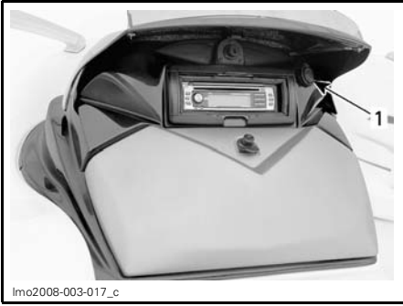
1. 12-volt power outlet
