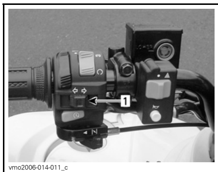
1. Interruptor de intermitente
