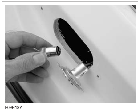
TYPIQUE — ENFONCER, TOURNER ET RETIRER L'AMPOULE
