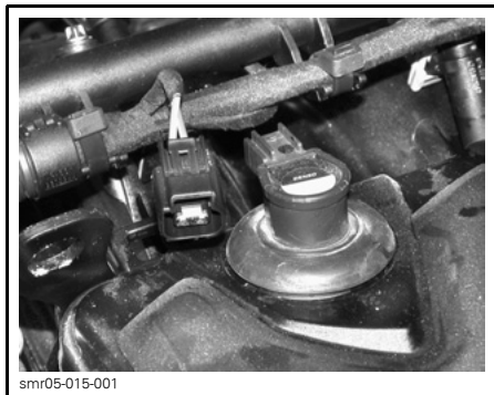
KOPPEL DE AANSLUITINGEN VAN DE ONTSTEKINGSSPOELLEN LOS
