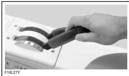
TYPIQUE — LEVIER SÉLECTEUR EN POSITION DE MARCHÉ ARRIÈRE
