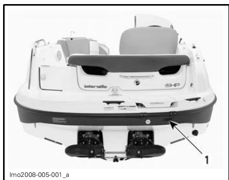
1. Numéro d'identification de la coque (N.I.C.)
