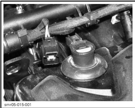
DÉBRANCHER LES CONNECTEURS DES BOBINES D'ALLUMAGE
