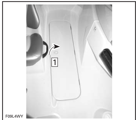
TYPIQUE Étape 1: Tirer le verrou et soulever le couvercle
