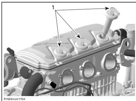
1. Bobinas de encendido
