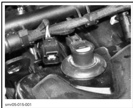
**DESLIGUE OS CONECTORES DA BOBINA DE IGNIÇÃO**
