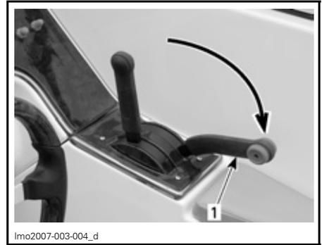
1. Para poder cambiar, la palanca de aceleración debe estar totalmente retrasada (velocidad de ralentí)
