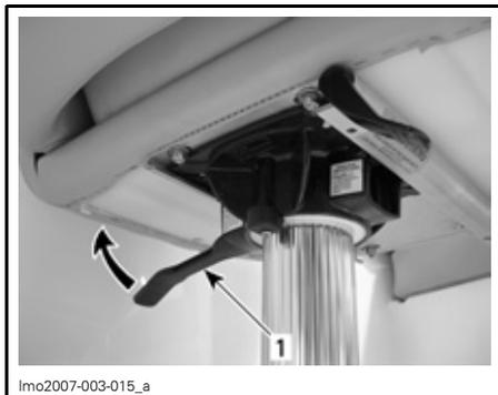
**TIRE DE LA PALANCA DEL LADO DERECHO DEL ASIENTO Y NO LA SUELTE**
