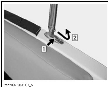
Paso 1: Presione sobre el dispositivo e bloquee
