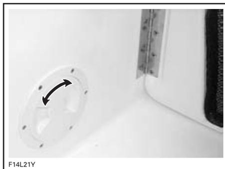
EM CASO DE INCÊNDIO NO COMPARTIMENTO DO MOTOR, DESENROSCUE A TAMPA, LIGUE O BICO DO EXTINTOR E DESCARREGUE
