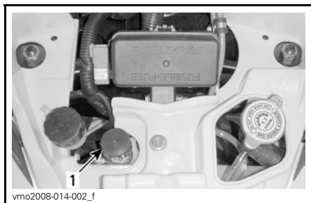
1. Serbatoio liquido refrigerante
