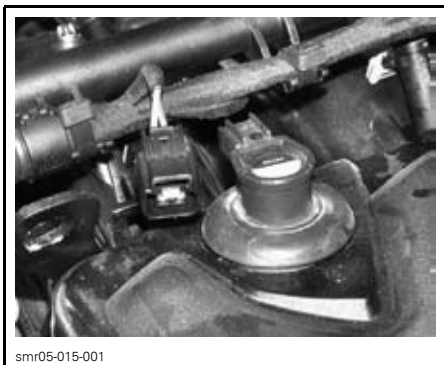
KOPPEL DE AANSLUITINGEN VAN DE ONTSTEKINGSSPOELEN LOS
