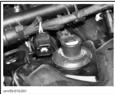
**DESLIGUE OS CONECTORES DA BOBINA DE IGNIÇÃO**
