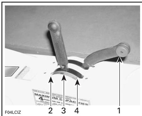
1. Le levier d'accélérateur doit être ramené complètement vers l'arrière (ralenti) pour changer de vitesse
