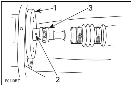
1. Volant moteur (côté PDM)
