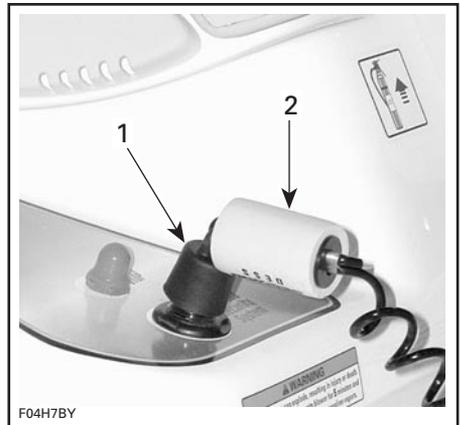
TYPIQUE — INTERRUPTEUR D'ARRÊT ET CORDON DE SÉCURITÉ
