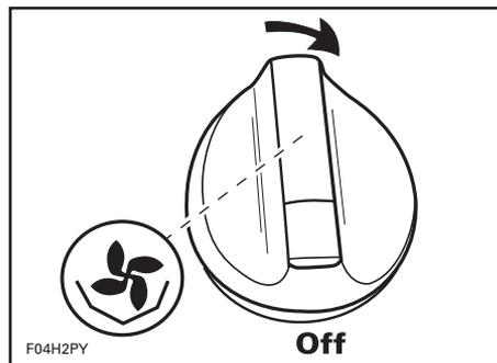
Cet interrupteur rotatif a deux positions («OFF» et «ON»). Lorsqu'on l'actionne, le ventilateur permet d'aérer le compartiment moteur.
