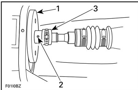
1. Volant moteur (côté PDM)
