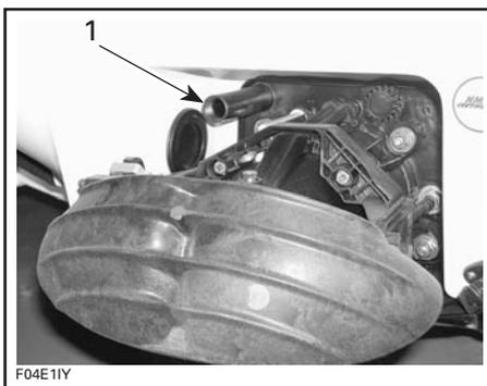
1. Raccord de rinçage au niveau de la pompe
