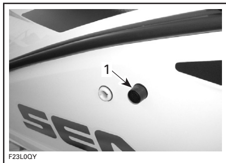
TYPIQUE — CHALLENGER 180 1. Aération du réservoir d'essence
