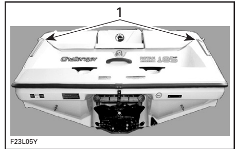
TYPIQUE 1. Conduits de ventilation
