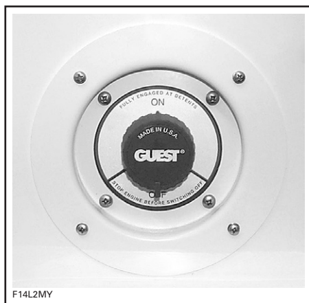
TYPIQUE — INTERRUPTEUR COUPE-CIRCUIT PRINCIPAL DE LA BATTERIE
