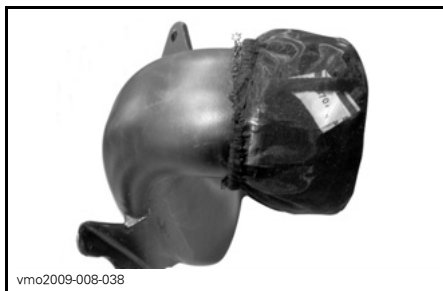
CVT-LUFTINNTAK FJERNET FOR BEDRE OVERSIKT
