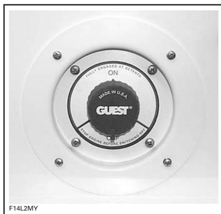
Lorsque l'interrupteur est à «OFF», TOUS les accessoires électriques et électroniques sont éteints, à l'exception de la pompe de cale. La pompe de cale se mettra en marche automatiquement même si l'interrupteur coupe-circuit principal de la batterie est à «OFF».
