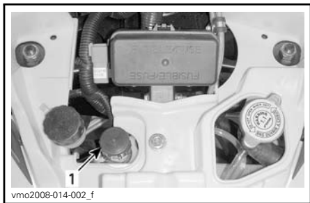
1. Réservoir de liquide de refroidissement
