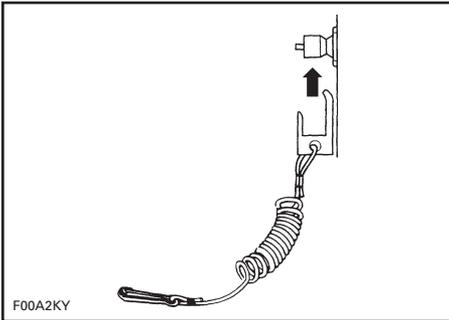
TYPICAL — IGNITION INTERRUPTER (STOP SWITCH) WITH LANYARD
