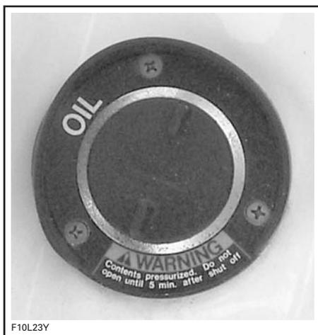
Pour ajouter de l'huile à injection dans le réservoir, dévisser le bouchon dans le sens antihoraire.
