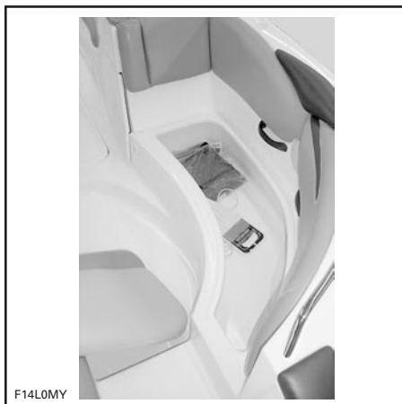
BÂBORD — SOULEVER LE SIÈGE POUR ACCÉDER À CE COMPARTIMENT DE RANGEMENT
