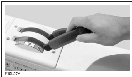
TYPIQUE — LEVIER SÉLECTEUR EN POSITION DE MARCHE ARRIÈRE
