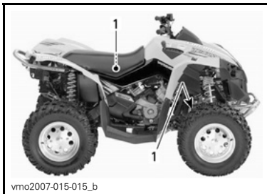
1. Position des Hinweisschildes mit Fahrzeugseriennummer
