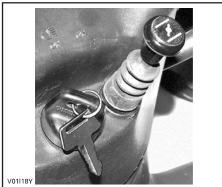
LEVIER D'ÉTRANGLEUR EN POSITION «FULL CHOKE»
