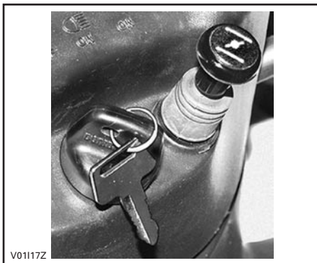
LEVIER D'ÉTRANGLEUR EN POSITION «OFF»
