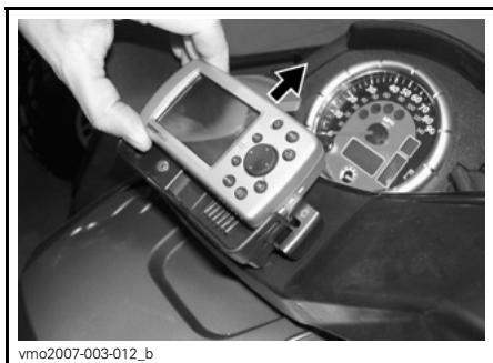
TYYPILLINEN — IRROTA LIU'UTTAMALLA
