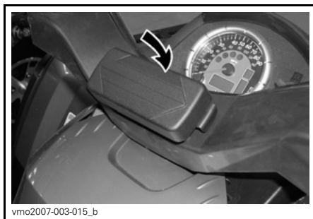
TYYPILLINEN — ASENNA SUOJAKANSI
