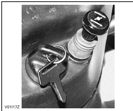
PALANCA DE POMO DEL ESTRANGULADOR DE AIRE EN POSICIÓN DE CIERRE
