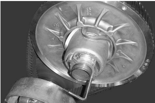
TYPEBILDE – FORLENGER FOR DRIVREIMSKIVE MONTERT PÅ JUSTERINGSNAV
