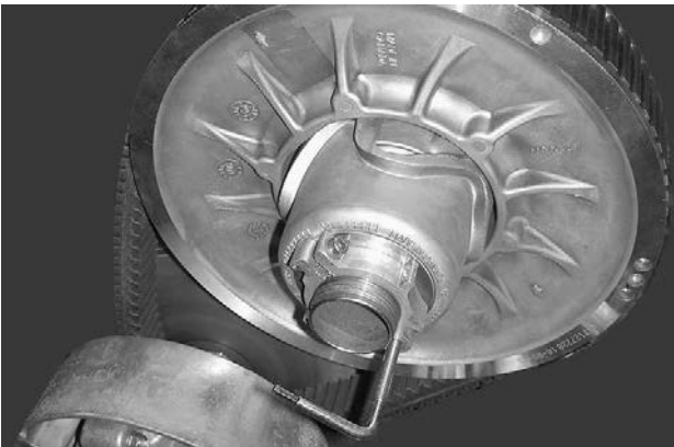
TYPBILD - VARIATORUTVIDGARE INSTALLERAD PÅ JUSTERINGSNAVET
