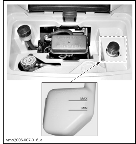
DEPÓSITO DEL REFRIGERANTE
