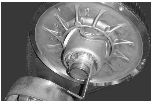
TYPBILD - VARIATORUTVIDGARE INSTALLERAD PÅ JUSTERINGSNAVET
