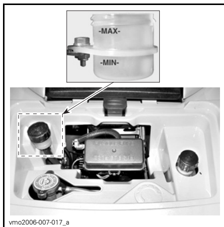
BEHÄLTER FÜR BREMSFLÜSSIGKEIT DES BREMSPEDALS
