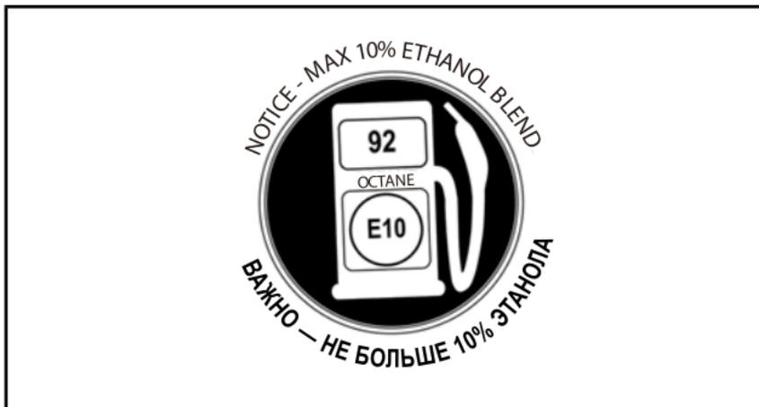
НАХОДИТСЯ НА КРЫШКЕ ТОПЛИВНОГО БАКА — НА ДВИГАТЕЛЕ 600 EFi (В СТРАНАХ, ГДЕ ИСПОЛЬЗУЕТСЯ ОКТАНОВОЕ ЧИСЛО RON)
