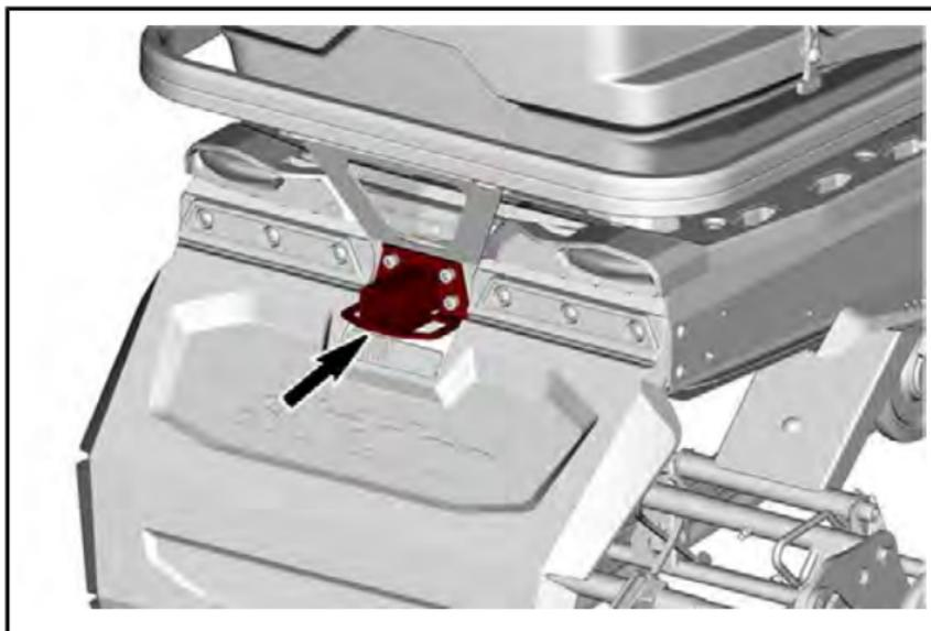
Сцепное устройство можно использовать для буксировки различных грузов. Используйте буксировочную тягу.
