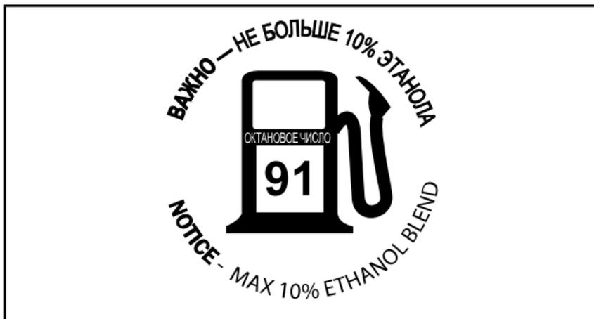
НА КРЫШКЕ ТОПЛИВНОГО БАКА — НА ДВИГАТЕЛЕ 600R E-TEC (В СТРАНАХ, ГДЕ ИСПОЛЬЗУЕТСЯ ОКТАНОВОЕ ЧИСЛО AKI (RON+MON)/2)
