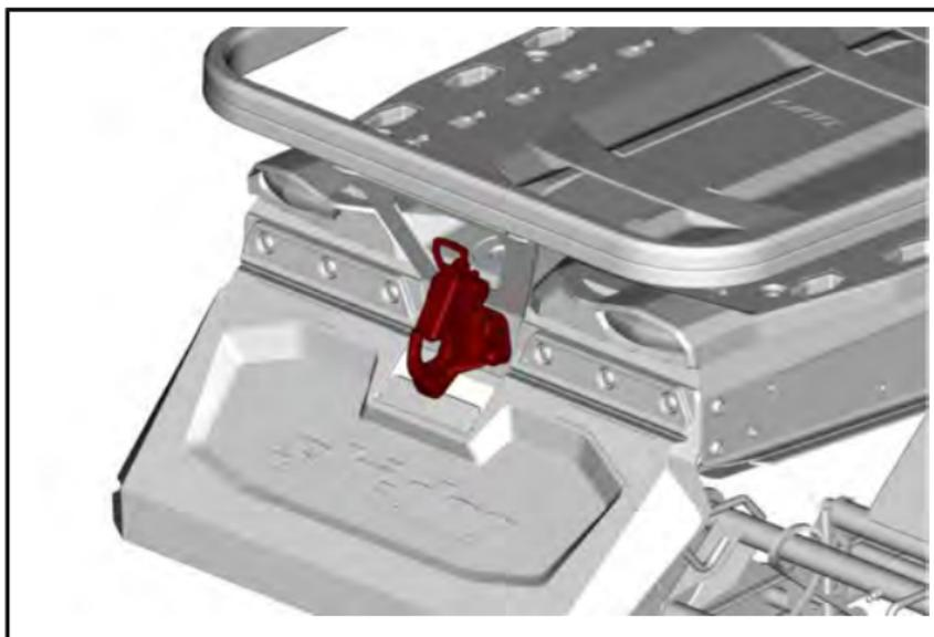
フックを開くには、ハンドルを押して回し、ロックングプレートを引き込みます。
