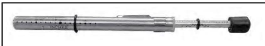
5. ボトムリングを使用して、たわみを40 mm ～ 50 mmに設定します。
